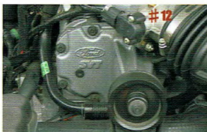
#11 5.4ℓ V8のエンジンは、スポーツモードで最高出力525Hpを発揮する。#12 水冷インタークーラー付きスーパーチャージャーを搭載。#13 セルジオ氏の自社で現在開発中の8チャンネルイグニッションシステムが取り付いている。#14 足回りにビルシュタインを装着し、走行性を向上。#15 特別仕様の車両を作るチームがSVT。所々にSVTのレタリングを見ることができる。#16 インパネは操作性を考慮した配置だ。#17 オートシートのドライバーズシート。#18 ホワイトメーターは140マイル表示だ。#19 & #20 オーバーヘッドコンソール内のスイッチ一つで、瞬時にスポーツモードとノーマルモードの変換が可能である。
