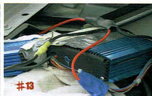
#11 5.4ℓ V8のエンジンは、スポーツモードで最高出力525Hpを発揮する。#12 水冷インタークーラー付きスーパーチャージャーを搭載。#13 セルジオ氏の自社で現在開発中の8チャンネルイグニッションシステムが取り付いている。#14 足回りにビルシュタインを装着し、走行性を向上。#15 特別仕様の車両を作るチームがSVT。所々にSVTのレタリングを見ることができる。#16 インパネは操作性を考慮した配置だ。#17 オートシートのドライバーズシート。#18 ホワイトメーターは140マイル表示だ。#19 & #20 オーバーヘッドコンソール内のスイッチ一つで、瞬時にスポーツモードとノーマルモードの変換が可能である。
